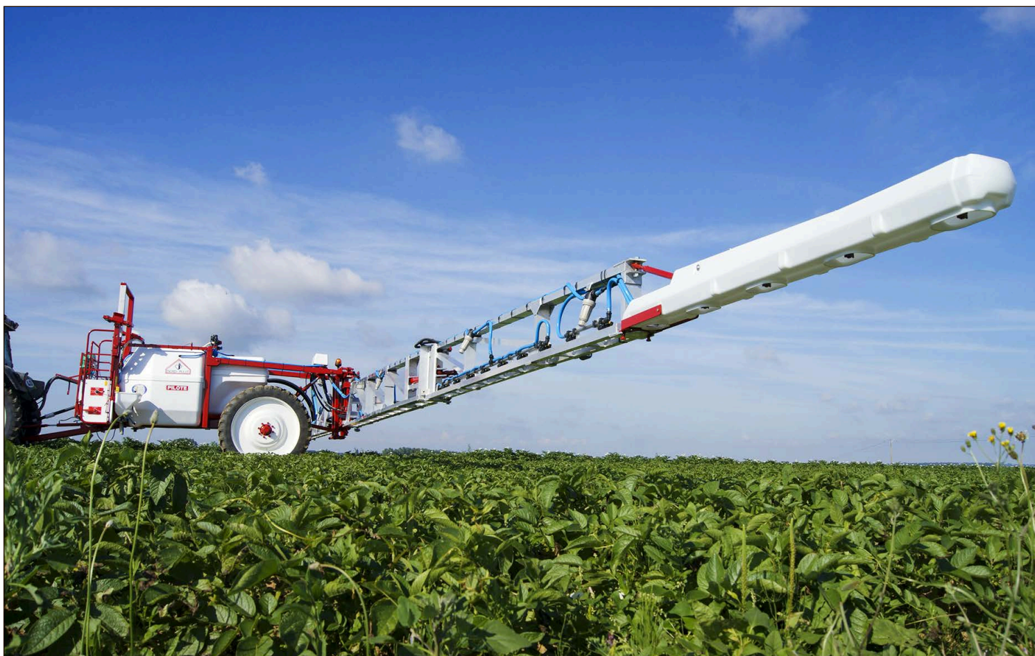
Que ce soit par les coupures de tronçons par GPS généralisées sur les nouveaux modèles de pulvérisateurs ou par l'utilisation de buses permettant une qualité d'application grâce à des gouttes de taille adaptée entre autres, la pulvérisation se module et se fait toujours plus précise, pour une économie d'intrants et une facilité de mise en œuvre.
